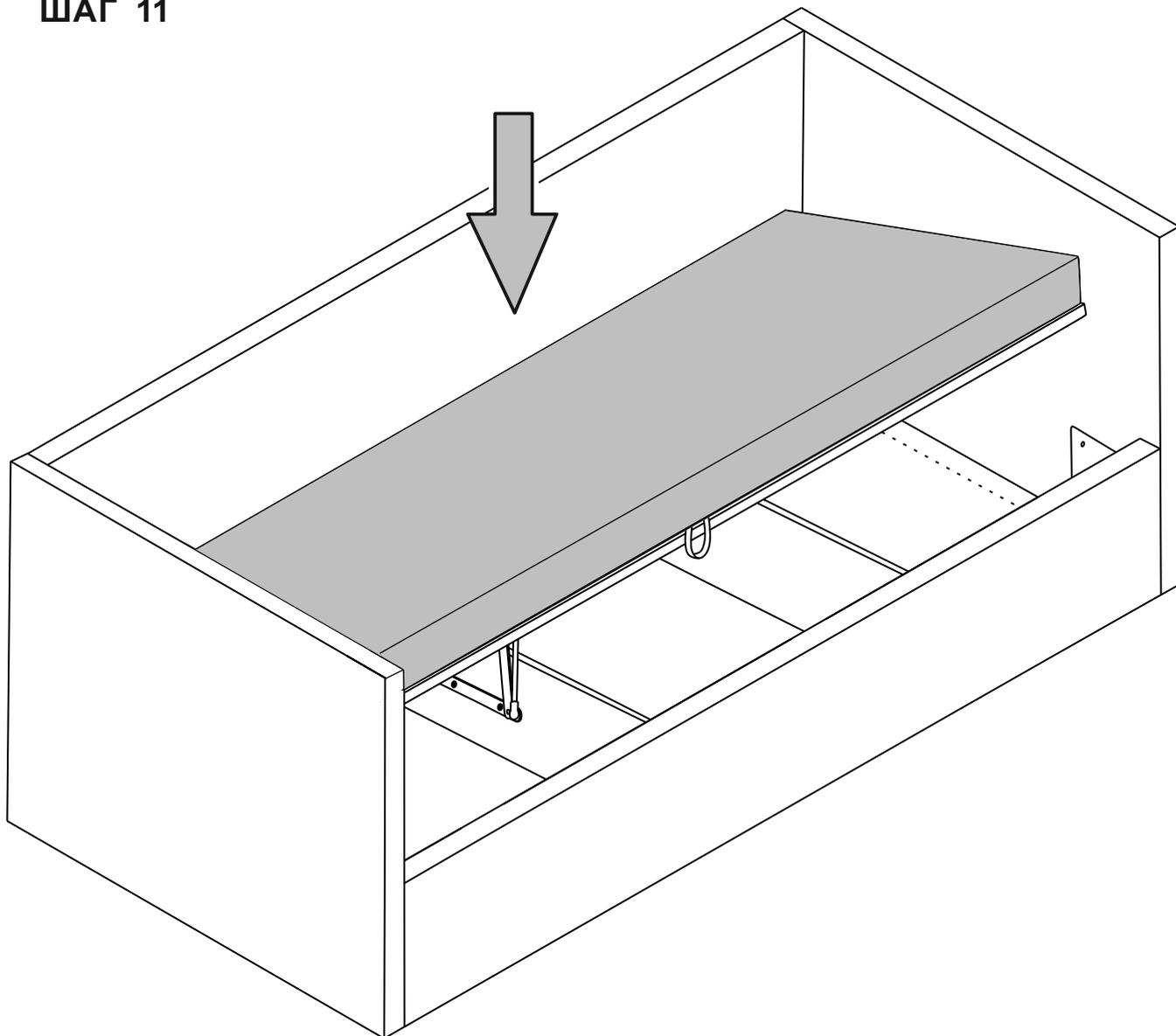
**ВНИМАНИЕ:** технологический зазор 30 мм по периметру между щитом из ЛДСП и внутренней частью бельевого короба.
