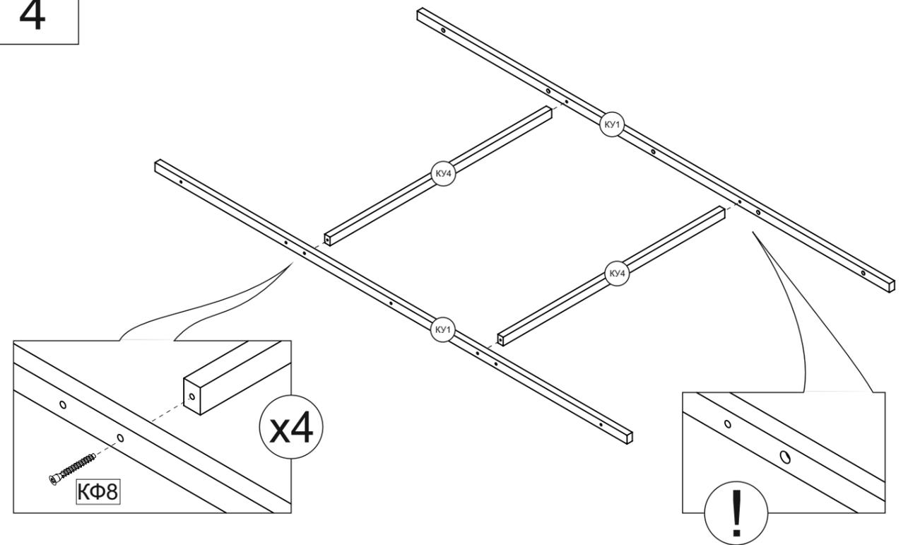
Обратите внимание на упоры КУ1: отверстия с большим диаметром должны находиться на внутренней стороне конструкции.
