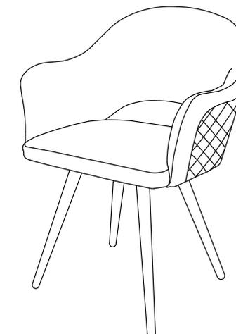
После сборки изделия допускается отклонение от плоскостности 4 ножек до 1,5 мм, которое нивелируется в процессе эксплуатации
