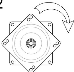
Для удобства монтажа необходимо повернуть верхнюю часть поворотного механизма относительно нижней на 45°
