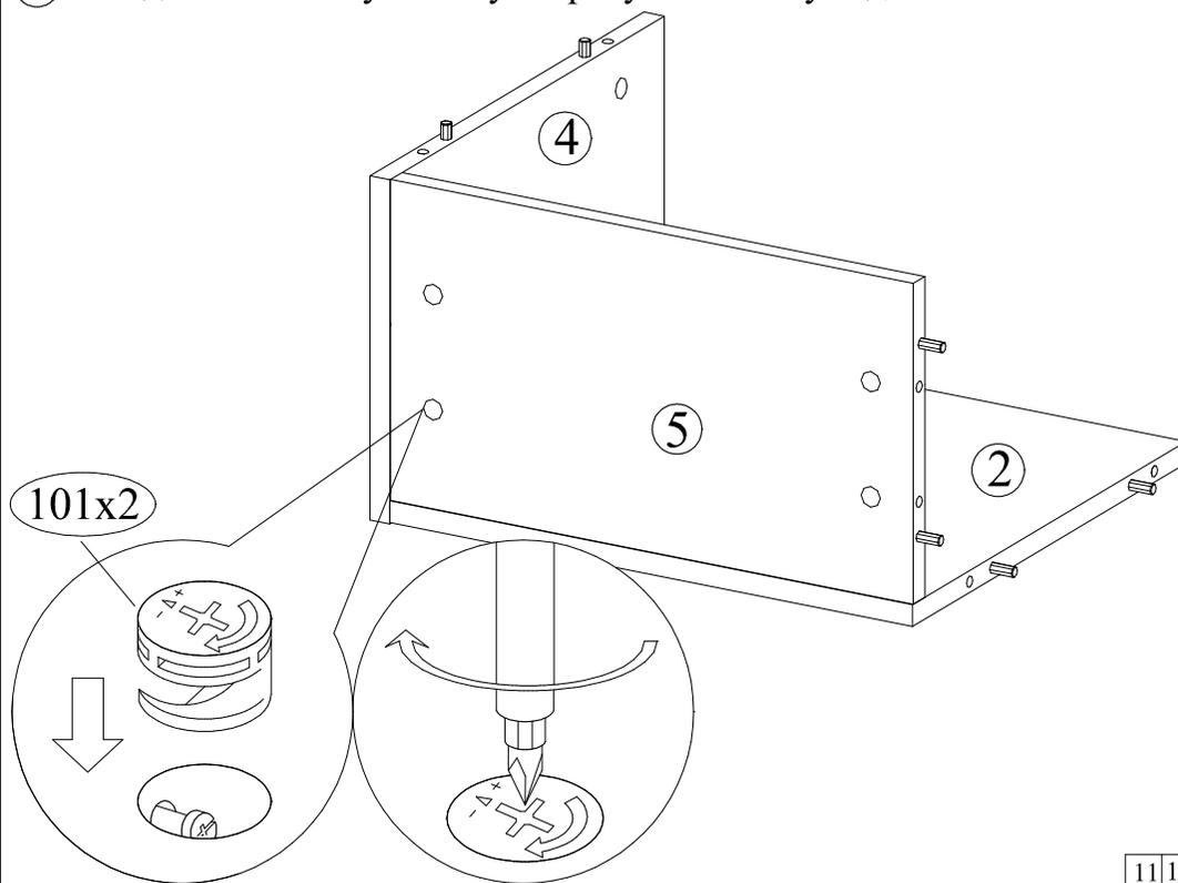
3 Закрутить дюбели в крышку, прикрутить уголки
