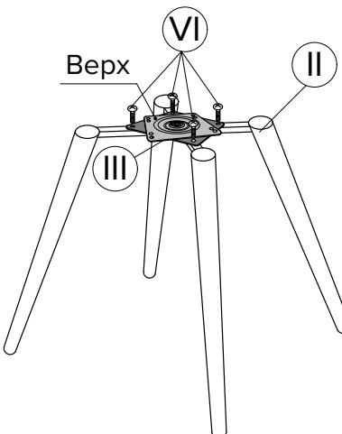
Для удобства монтажа необходимо повернуть верхнюю часть поворотного механизма относительно нижней на 45°
