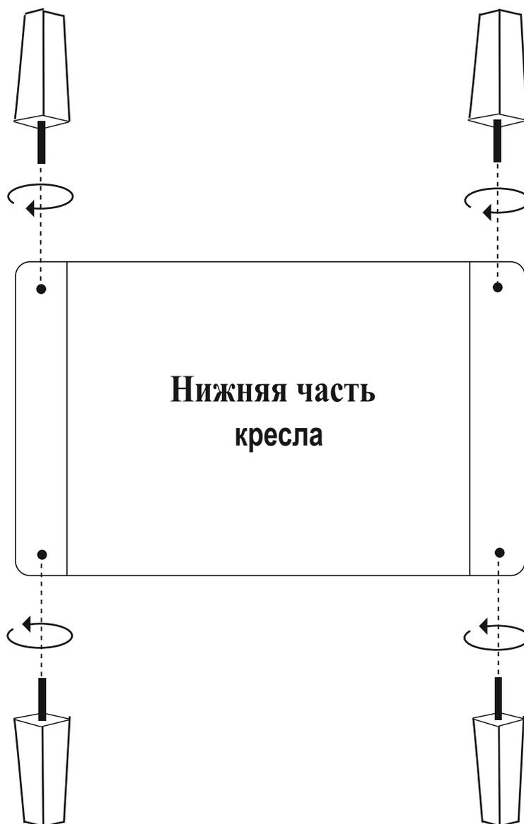
2. Вкрутить ножки на шпильке в отверстия на нижней части кресла
