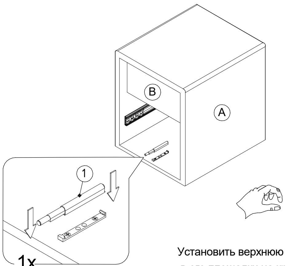
Установить верхнюю часть толкателя K-Push 40 мм
