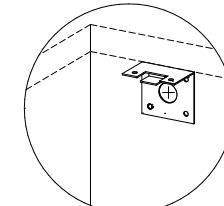
2 просверлить отверстие в стенке задней и в стене
