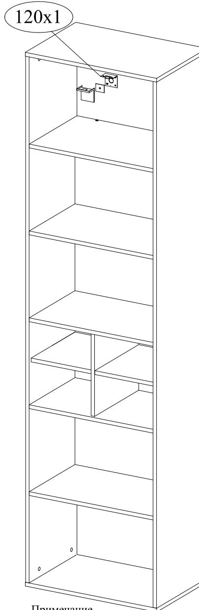
1 приложить уголок к крышке и стенке задней. В стенке задней отметить положение отверстия
