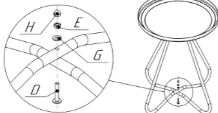
Опоры А и В собрать в соответствии со схемой.
