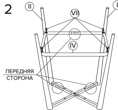
Внимание! Маркировка ПЕРЕДНЯЯ СТОРОНА на кольце находится с той же стороны, что и на опоре. При сборке опоры обратите внимание на размер и расположение винтов.
