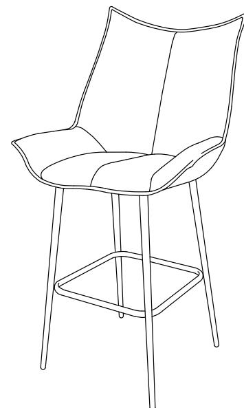
После сборки изделия допускается отклонение от плоскостности 4 ножек до 1,5 мм, которое нивелируется в процессе эксплуатации
