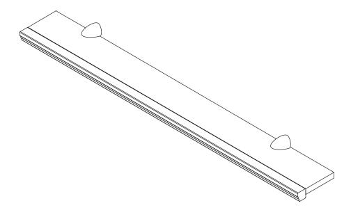
высота — 35 мм ширина — 1400 мм глубина — 185 мм
