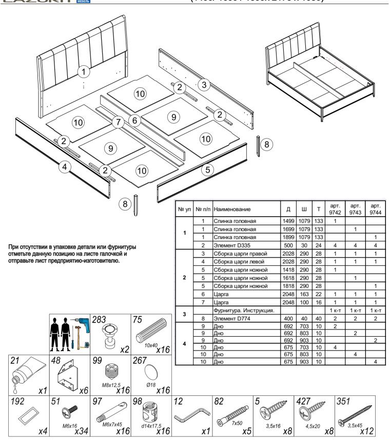
Уважаемый покупатель! Проверьте наличие деталей и фурнитуры, согласно комплектовочной ведомости Сборку следует производить, придерживаясь порядка и последовательности данной инструкции. Для исключения царапин защитную пленку снять после сборки изделия. Во избежание перекосов и других дефектов проводите сборку на ровном полу, покрытом тканью или мягкой бумагой.
