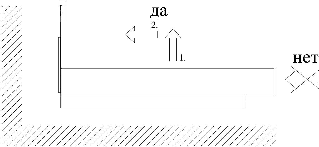
**Внимание! Кровать должна быть установлена вплотную к стене. Наличие зазоров из-за плинтуса и неровных стен НЕ ДОПУСКАЕТСЯ!**
