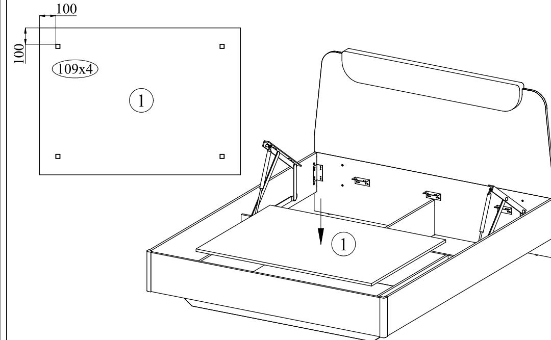
26 Согласно инструкции собрать кроватное основание и прикрутить. Технологические отверстия заклеить заглушками.
