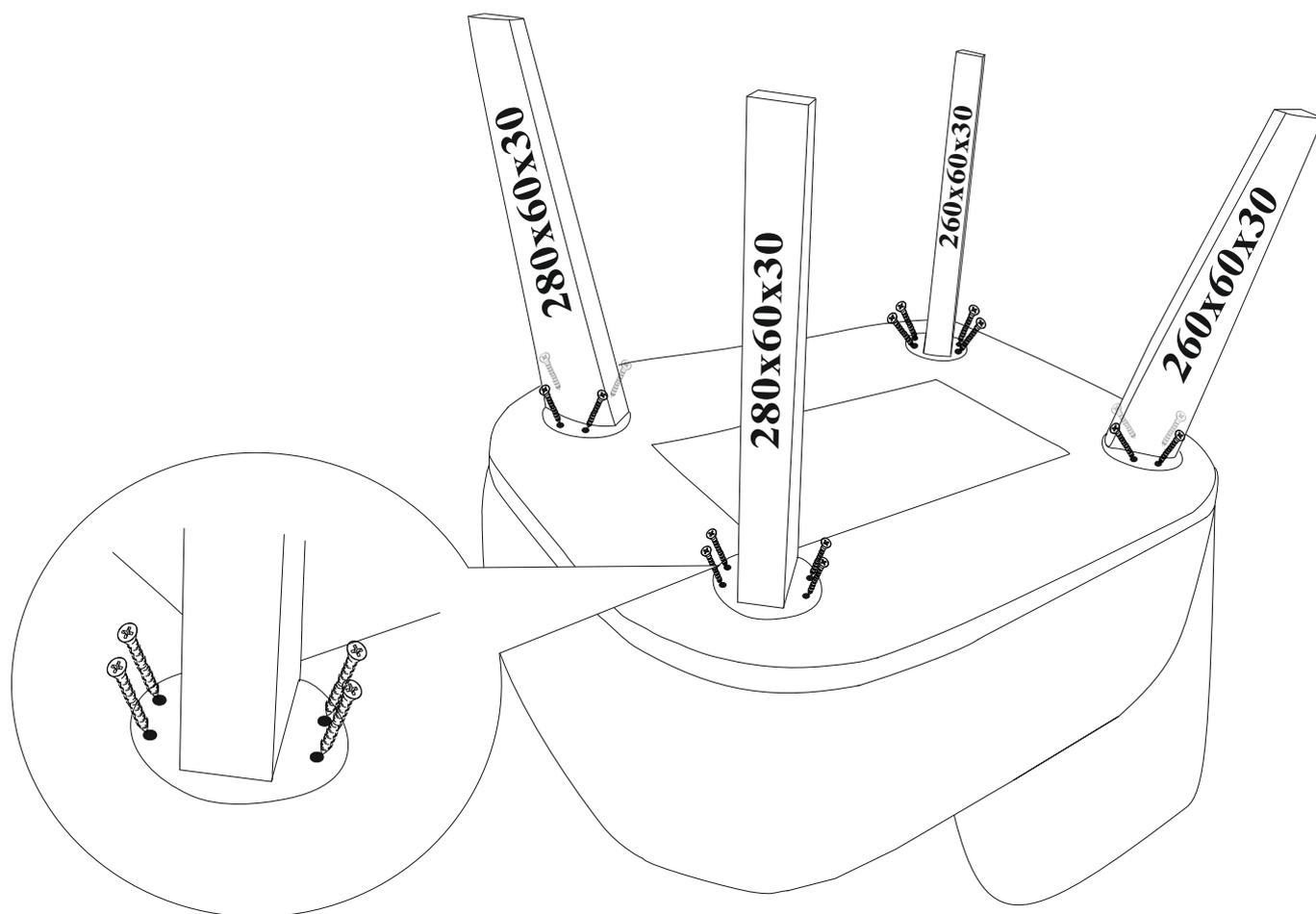
Большие ножки прикручиваются саморезами на переднюю часть, малые на заднюю часть нижней площадки изделия.
