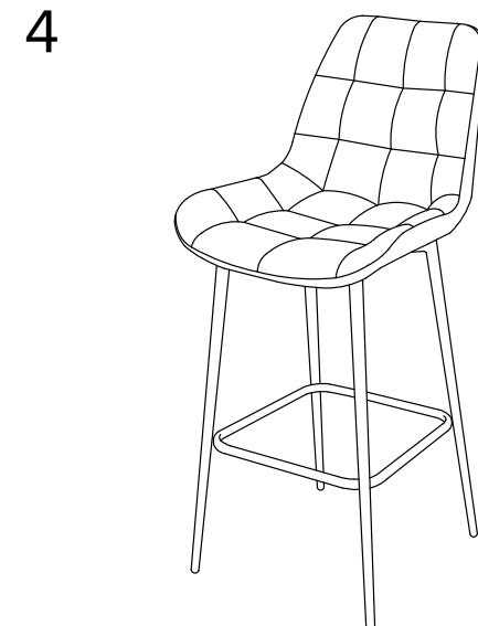
После сборки изделия допускается отклонение от плоскостности 4 ножек до 1,5 мм, которое нивелируется в процессе эксплуатации
