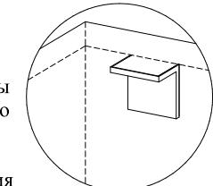
⑯ Выровнять шкафы. Просверлить отверстия. Соединить межсекционными стяжками.
