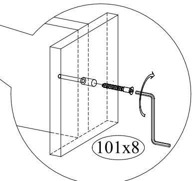
13) Вставить в полки эксцентриковые стяжки
