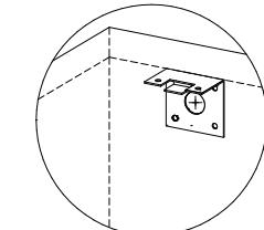
2 просверлить отверстие в стенке задней
