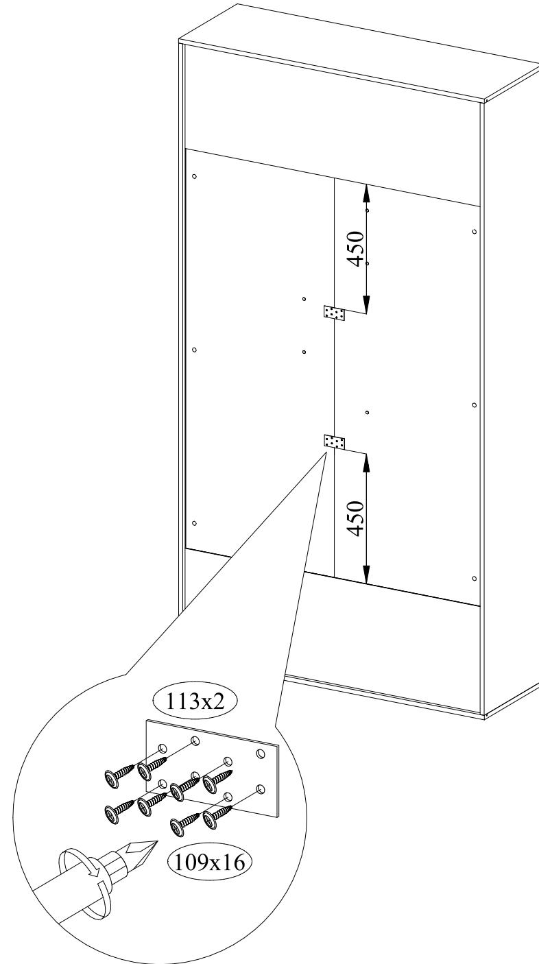
⑪ Вставить стенку заднюю. Выровнять диагонали. Закрепить стенку заднюю.
