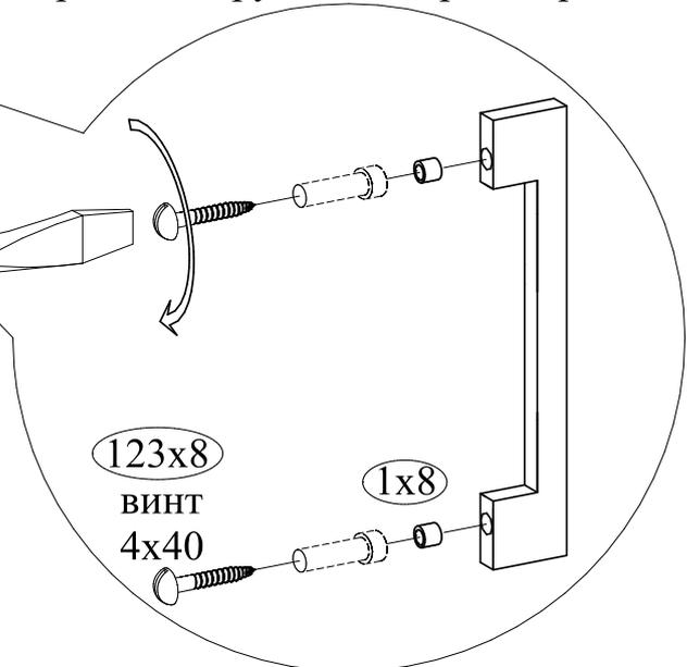
**Внимание!** Винты закручивать отверткой до упора, без лишних усилий.
