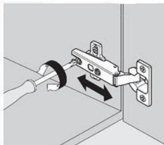
Регулировка по глубине
