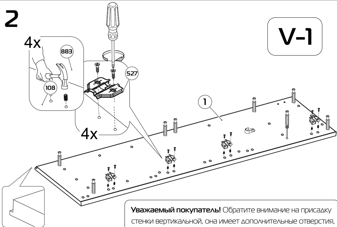
**Уважаемый покупатель!** Обратите внимание на присадку стенки вертикальной, она имеет дополнительные отверстия, которые задействованные при установке планки петли. Убедитесь какой вариант двери вы приобрели . Приложите дверь к стенке вертикальной для правильной установки планки петли.
