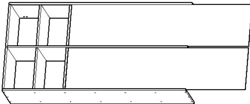
*Установить витрину в вертикальное положение и монтировать крышку.
