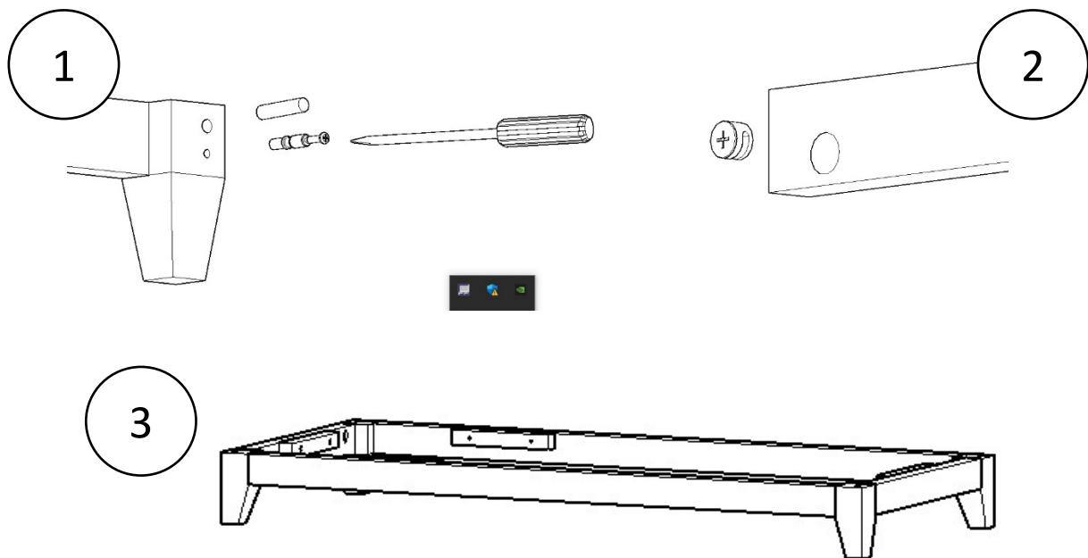
Установить эксцентриковые стяжки в отверстия Ø20мм и ввинтить дюбели в соответствующие отверстия Ø5мм:
