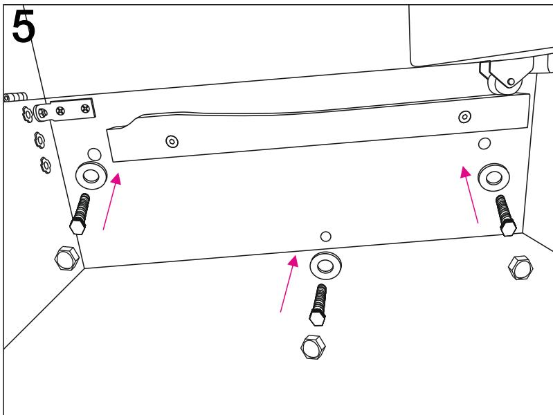
С помощью шайб⑥ и болтов⑦ закрепить подлокотники с внутренней стороны короба в соответствующие отверстия. На болты⑦ установить колпачки⑩
